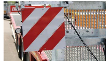
Am Schwanenhals und an den Rampen links und rechts jeweils eine Halterung für die Warntafeln inklusive Steckdose
