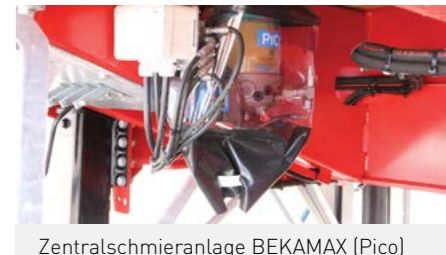
Zentralschmieranlage BEKAMAX (Pico) mit Normalfett NLGI-2 und abnehmbarem Schutz um die Pumpe.
