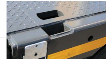
Rungentaschen für Steckungen 100 x 50mm im Außenrahmen der Ladefläche.
