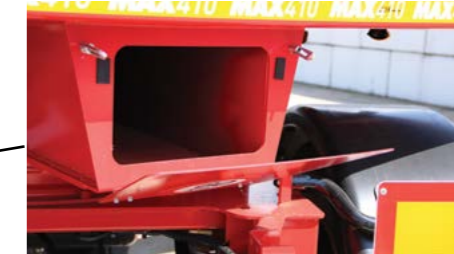
Ablage für Steckungen im Zentralträger hinten
