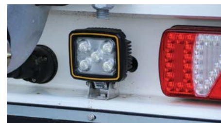
LED Arbeitsscheinwerfer auf dem Heckblech montiert.
