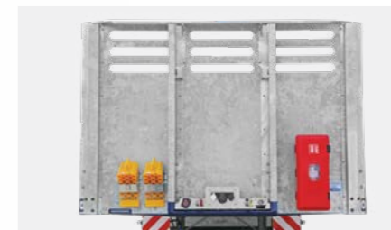
Eine verzinkte Stirnwand 1.600mm hoch.
