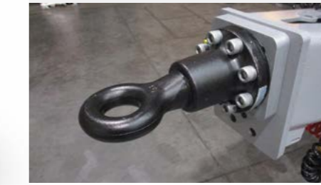
Eine +/- 1.750mm lange Deichsel, mit einer Zugöse (50mm, 57mm oder 68mm Durchmesser).
