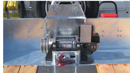
Elektrische Seilwinde mit Funkfernbedienung ca. 5.400kg Hubkraft, inkl. 9,5mm starkem Drahtseil 24m lang mit Seilführungsrolle.
