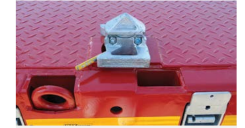
Rungentaschen für Steckungen 100 x 50mm im Außenrahmen der Ladefläche.
