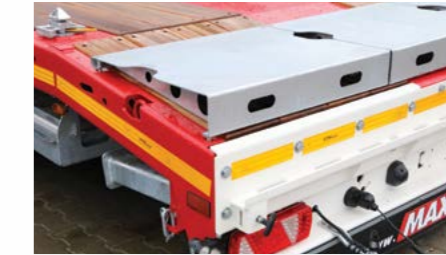
Ausgleichkeil galvanisiert für Abschrägung 1.000 x 8°.
