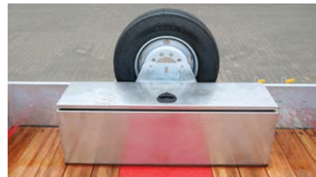
Werkzeugkasten INOX auf dem Schwanenhals ca. 1.350 x 400 x 400mm.
