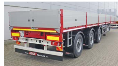
Klappbare Alu-Bordwände ca. 600mm hoch mit Kinnegrip Klapprungen.
