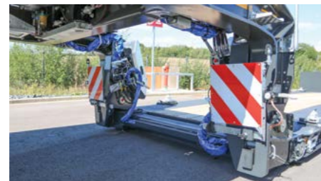
Um ca. 400mm ausziehbare Warntafeln ca. 423 x 423mm mit einer LED-Positionleuchte.
