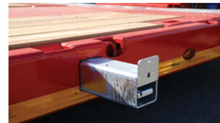
Verbreiterungen verzinkt, ausziehbar um ca. 230mm je Seite.
