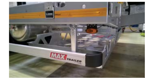
Eine verzinkte Halterung quer unter der Ladefläche. (2.410 x 1.025mm).
