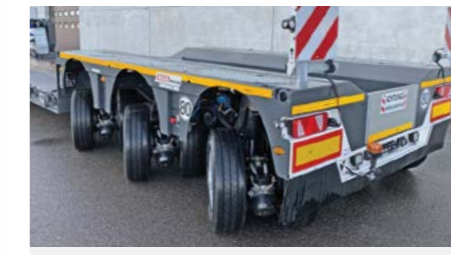
3-Achs Fahrwerk „PENDEL-AXLE“, alle Achsen hydro-mechanisch zwangsgelenkt.
