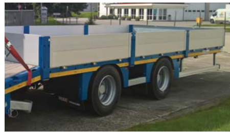
Klappbare Alu-Bordwände (eloxiert) seitlich an der Ladefläche, ca. 400 mm hoch.
