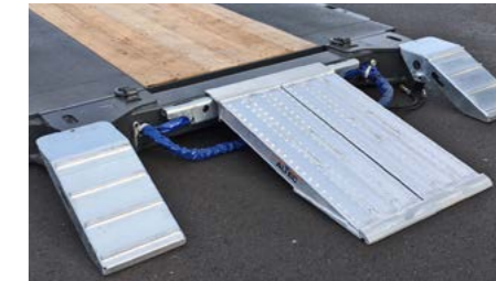
ALU-Anlegerampen zum Überbrücken der Aufnahmehaken des Tiefbetts.
