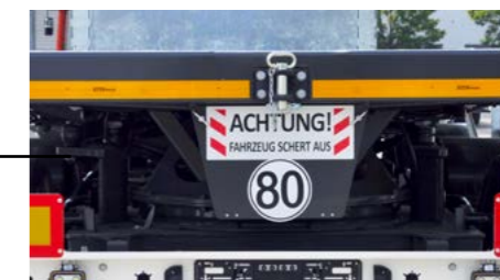
Rangierkupplung mit Verstärkung an der Schlussstraverse angeschraubt.
