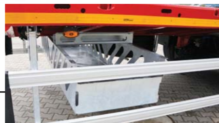
Verzinkte Halterung quer unter der Ladefläche (2.430 x 770 x 400mm).
