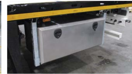
Ein Werkzeugkasten INOX 1.200 x 460 x 550mm unter der Ladefläche.
