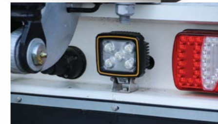
LED-Scheinwerfer auf dem Heckblech montiert.
