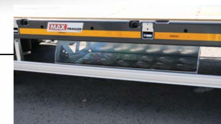
Eine verzinkte Halterung für die Verbreiterungsbohlen links unter der Ladefläche.
