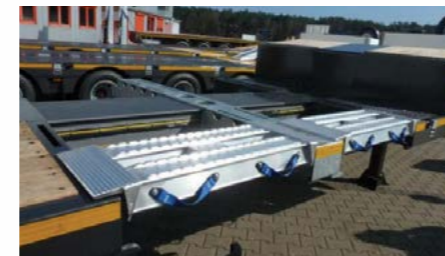
ALU-Überbrückungselemente ca. 1.160 x 420 x 120mm (für 1.000mm Auszug).
