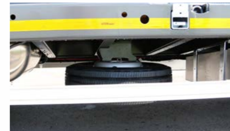
Reserverad mit Halter unter der Ladefläche in Fahrtrichtung rechts 235/75 R17.5
