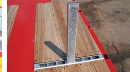
Rungentaschenleisten, quer in der Ladefläche montiert, für Steckungen 100 x 50mm.
