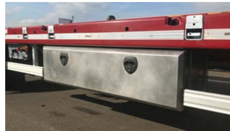
Werkzeugkasten INOX 1.500 x 390 x 810mm.
