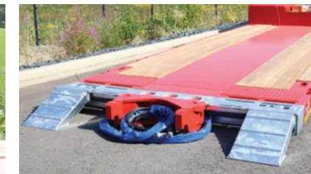
Stahl-Rampen zum Überbrücken der Aufnahmehaken des Tiefbetts.
