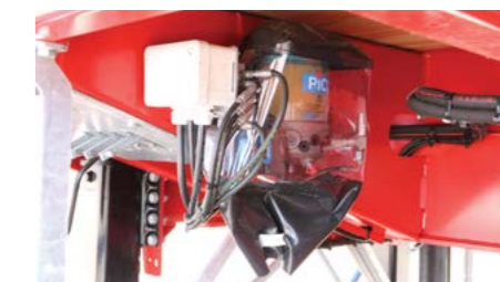
Zentralschmieranlage BEKAMAX (Pico) mit Normalfett NLGI-2 und abnehmbarem Schutz um die Pumpe. (nur MAX210)
