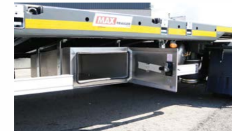
Werkzeugkasten INOX rechts 565 x 290 x 810mm.
