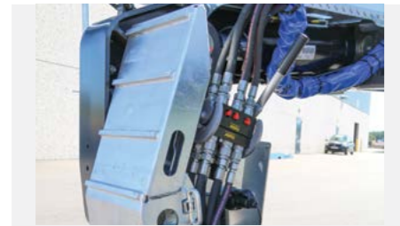
Hydraulikanschlüsse vom Schwanenhals zum Tiefbett mit Multikupplung anstelle Schraubkupplungen. Ohne Garantie auf Dichtungen.
