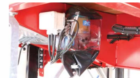
Zentralschmieranlage mit 2 Pumpen BEKAMAX (Pico) mit Normalfett NLGI-2 und abnehmbarem Schutz um die Pumpe.
