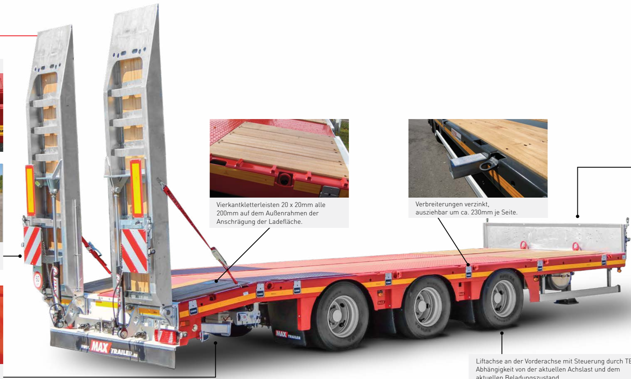
Um ca. 400mm ausziehbare Warntafeln ca. 423 x 423mm mit einer LED-Positionsleuchte.
