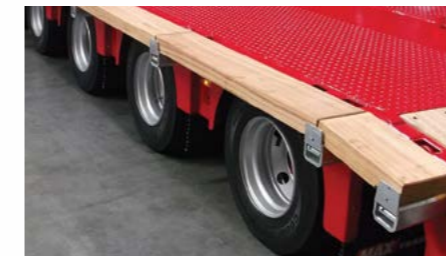
Verbreiterungen verzinkt, ausziehbar um ca. 230mm je Seite. Verbreiterungsbohlen aus Hartholz.
