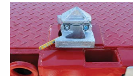
WADER Containertaschen in der Ladefläche für 20" Container. WADER Containerverriegelungen.
