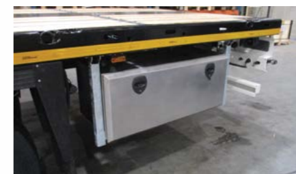
Werkzeugkasten INOX hinten unter der Ladefläche 1.200 x 460 x 550mm.
