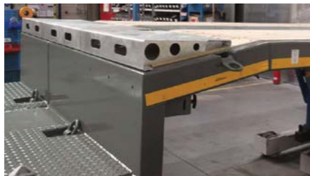
Ausgleichkeil galvanisiert für Abschrägung vorne 750 x 10°.
