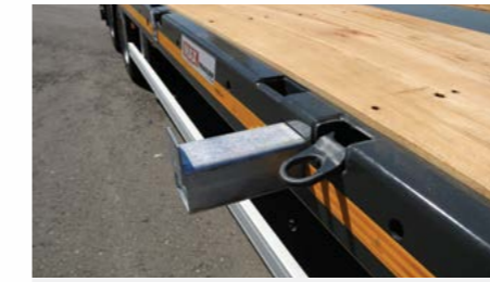
Verbreiterungen verzinkt, ausziehbar um ca. 230mm je Seite.
