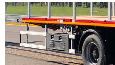
Werkzeugkasten HDPE 1200x500x480 vorne unter der Ladefläche in Fahrtrichtung links
