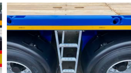
Aufstiegsleiter in Fahrtrichtung links und/oder rechts montiert.
