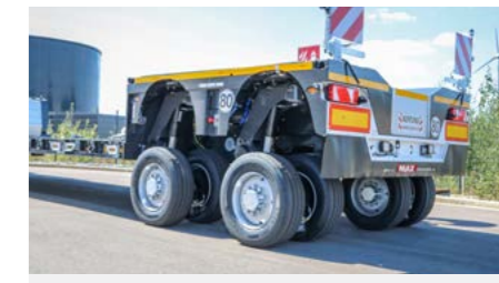
2-Achs Fahrwerk „PENDEL-AXLE“, alle Achsen hydro-mechanisch zwangsgelenkt.
