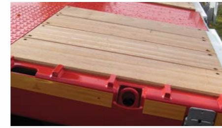
Vierkantkletterleisten 20 x 20mm alle 200mm auf dem Außenrahmen der Ansträgung der Ladefläche.
