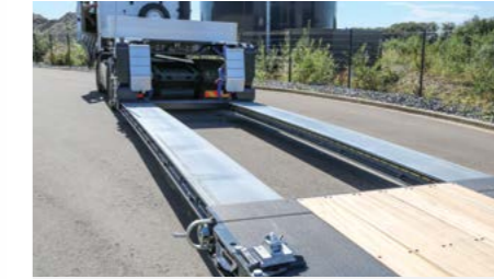
Tiefbett mit außenliegenden Trägern in ausziehbarer Ausführung mit festem Hartholzboden ca. 40mm dick und pneumatisch betätigter Verriegelung.
