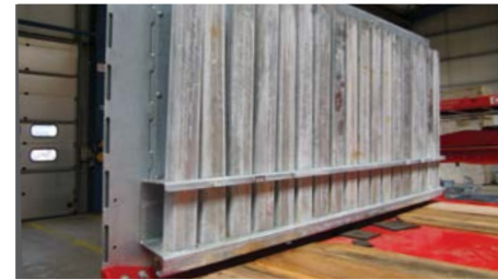
Ablage Steckungen ca. 100 x 50mm an der Stirnwand innen verschraubt.
