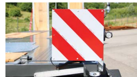
Um ca. 400mm ausziehbare Warntafeln ca. 423 x 423mm mit einer LED-Positionsleuchte.
