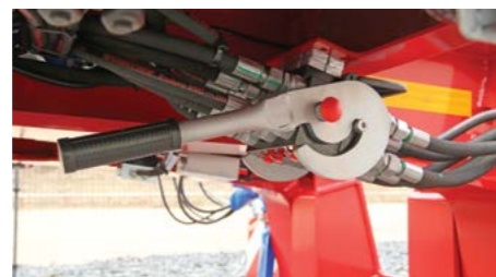
Hydraulikanschlüsse vom Schwanenhals zum Tiefbett mit Multikupplung anstelle Schraubkupplungen. Ohne Garantie auf Dichtungen.
