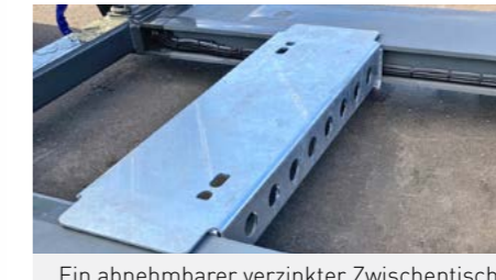
Ein abnehmbarer verzinkter Zwischentisch 500mm breit.
