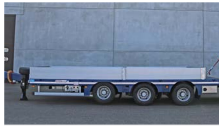
Alu-Bordwände (eloxiert) seitlich steckbar an der Ladefläche, ca. 400mm hoch.
