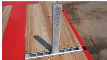
Rungentaschenleisten quer in der Ladefläche montiert.
