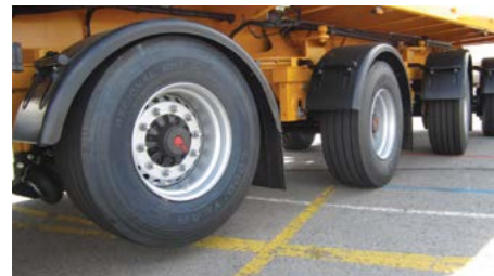
Liftachse an der Vorderachse mit Steuerung durch TEBS.
