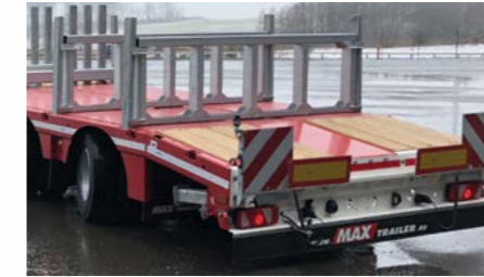
Ein verzinkter Auflagebock für die Ladefläche höhengleich mit dem Schwanenhals.
