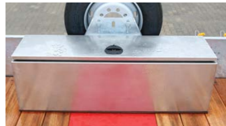
Ein Werkzeugkasten INOX auf dem Schwanenhals ca. 1.350 x 400 x 400mm.
