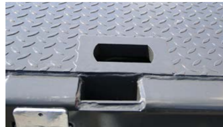
WADER Containertaschen in der Ladefläche, für 1x20' Container.
