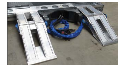
ALU-Anlegerampen VFR 120 zum Überbrücken der Aufnahmehaken des Tiefbetts.
