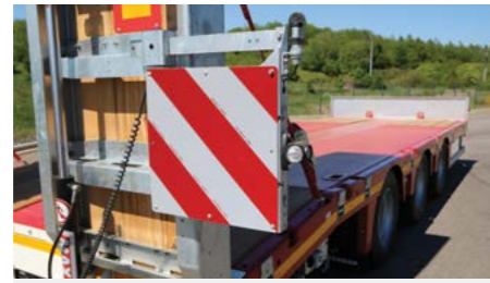
Um ca. 400mm ausziehbare Warntafeln ca. 423 x 423mm mit einer LED-Positionsleuchte.
