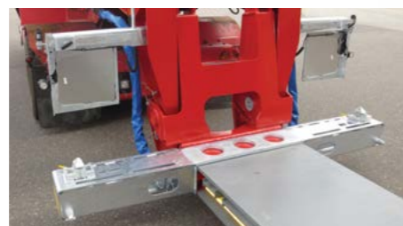
Ein abnehmbarer verzinkter Zwischentisch mit 1 Paar WADER Containertaschen. WADER Containerverriegelungen.
