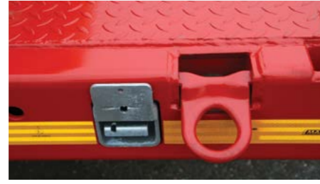
10t Verzurring nach außen klappbar.
