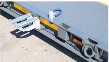
Klappbare Verbreiterungen, um ca. 230mm je Seite. Rungentaschen für Steckungen 100 x 50mm. 5 Paar Verzurringe nach außen klappbar.
