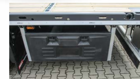
Werkzeugkasten HPDE unter der Ladefläche 620 x 360 x 610mm / 1.200 x 500 x 480mm.
