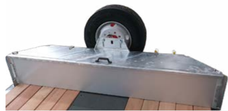
Werkzeugkasten galvanisiert, integriert im abgeschrägtem Schwanenhals.
