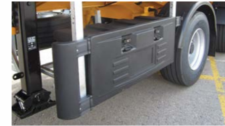
Ein Werkzeugkasten HDPE 1.200 x 500 x 480mm unter der Ladefläche.
