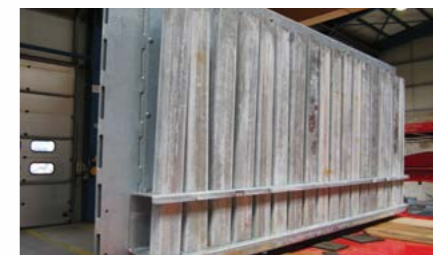
Ablage für Steckungen an der Stirnwand innen verschraubt.
