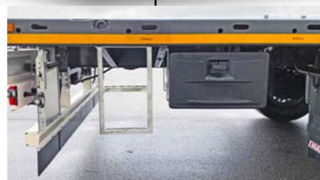
Aufstiegsleiter in Fahrtrichtung links und/oder rechts montiert. Werkzeugkasten HPDE unter der Ladefläche 620 x 360 x 610mm.
