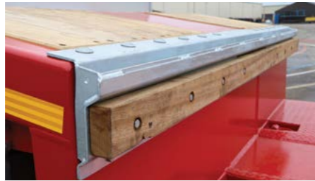
Einhängelleiste für ALU-Anlegerampen am Schwanenhals mit integriertem Rammschutz.
