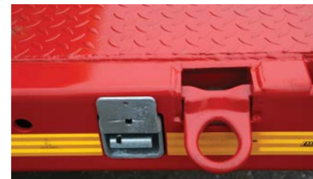
10t Verzurring nach außen klappbar.
