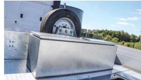
Ein Werkzeugkasten INOX auf dem Schwanenhals ca. 1.350 x 400 x 400mm.
