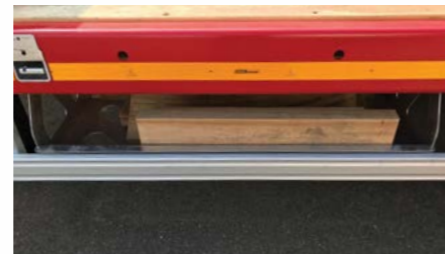
Eine verzinkte Halterung für die Verbreiterungsbohlen links und rechts unter der Ladefläche.
