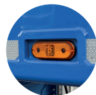
Eingelassene seitliche Beleuchtung
