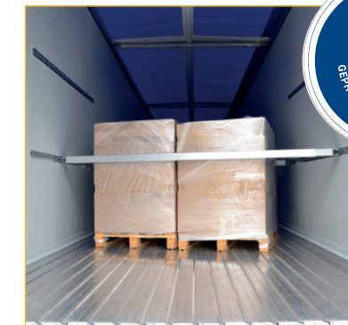
Sicherung der palettierten Ladung
