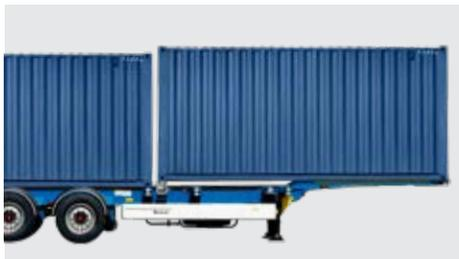
Befestigung des ersten 20' Containers am vorderen Holm - ermöglicht die Entladung direkt von der Frontseite des Fahrzeugs.
