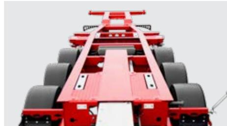
Eine Liftachse garantiert niedrigeren Rollwiderstand sowie Verbrauch und Reifenabnutzung.
