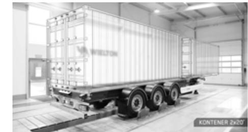
Optionale Ausstattung aus Aluminium: Sattelstützen, Luftbehälter, Felgen – Eigengewichtsreduzierung bis zu 210 kg.
