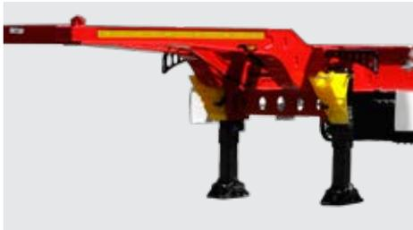
Leichter Seitenanfahrtschutz aus Verbundstoff mit Werbefläche. Leichter Zugang zum Werkzeugkasten.
