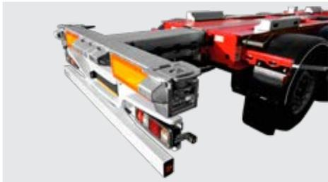
Heckausschub mit Plattform, für mittige Beladung von 20' Containern und Rampenentladung. Feste Frontgestaltung mit zwei Befestigungsvarianten.
