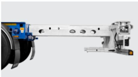
Mechanischer oder pneumatischer Heckausschub, angepasst zum Transport von allen Container-Arten.
