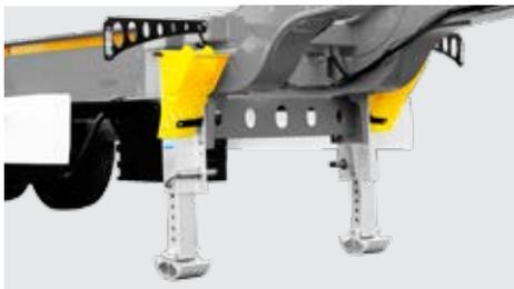
Sattelstützen aus Stahl bzw. Aluminium.
