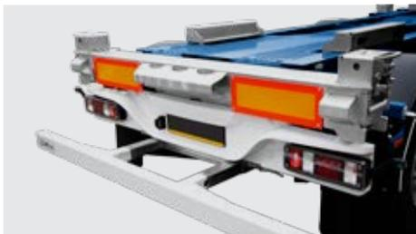
Das Heck des Aufliegers ist mit Stahlpuffern, Unterfahrschutz aus Stahl bzw. Aluminium und universellen höhenverstellbaren Verriegelungen ausgestattet.
