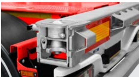
An Verladerrampen angepasster Unterfahrerschutz- und Leuchtenschutz.
