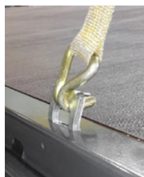
Ladungssicherungsösen im Boden eingelassen.
