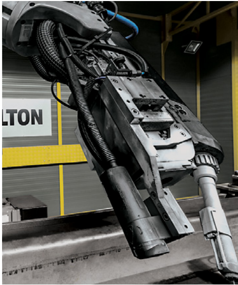
Polens größte autonome Station für das Hybridschweißen von Metallkomponenten im Fahrzeugbau.
