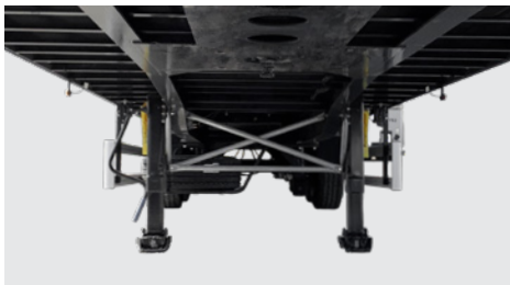
Rahmen in hochfestem S700- Leichtbau-Stahl.
