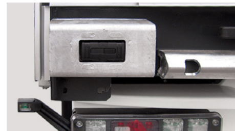
Rückfahrsensor im hinteren Stoßfänger.
