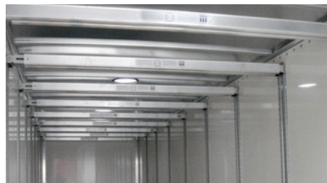
Schlüssellochleisten für Transport hängender Kleidung auf Stangen.
