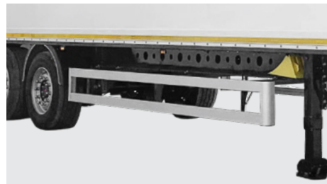
Seitlicher Unterfahrschutz, gefertigt aus Aluminium.
