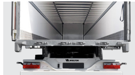
Hintere Rampenpuffer aus Stahl.
