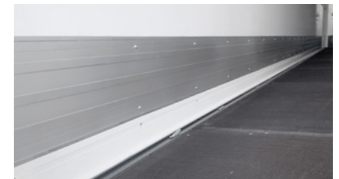
Aluminiumprofile zum Schutz der Seitenwände.
