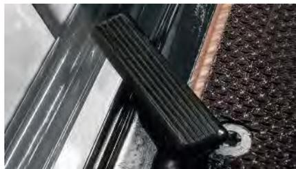
Glatte Konstruktion des Bodens aus 30 mm-starkerPlatte und zusätzliche Stopfen für Löcher im Rahmen an der Stelle der Ladungssicherung.
