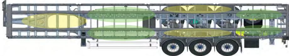
Die Reduzierung des Gesamtgewichts des neuen Modells wurde hauptsächlich durch die Verwendung alternativer Materialien wie hochfestem Stahl S700 oder den Ersatz von Stahl durch Aluminium in Komponenten wie Lufttanks, Stützbeinen, Stoßstange und Seitenstoßstangen erreicht.
